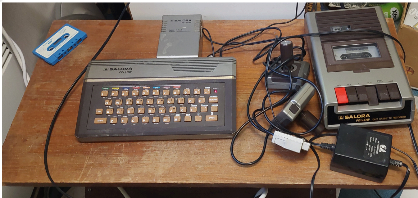
Fig. 2 - Il setup del mio Salora Fellow: il computer, il Datassette del Salora Fellow, due joystick, l'espansione di memoria da 16k e quel cavo a Y (cavo da stereo a doppio mono). Ora fa parte della mia famiglia. Quella cassetta blu non fa parte del Salora Fellow, fa parte della mia collezione MSX (SVI7x8). Penso che tutti sappiate cosa significa quando si è collezionisti, vero?
